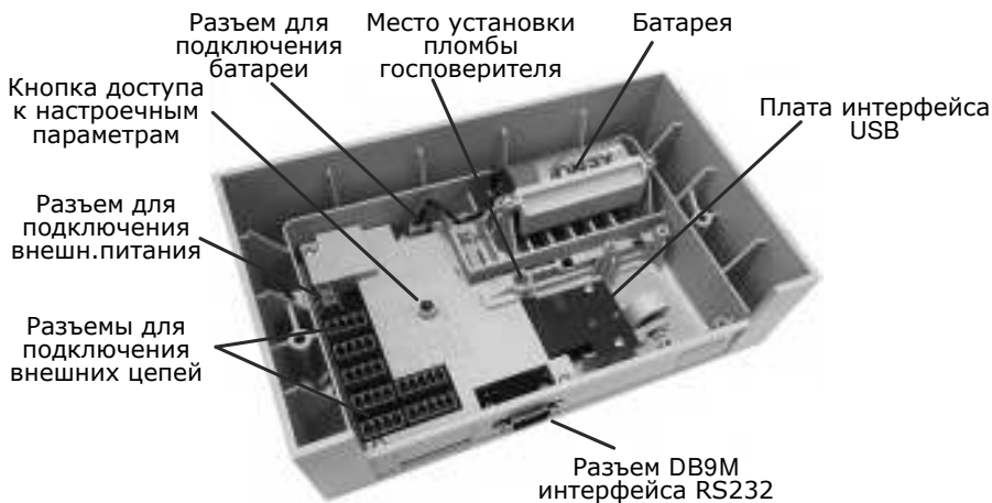
Рис. 2.3 – Вид снизу на приборный отсек ТВ7-04.1М Лайт
